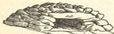
1. Aus Steinen aufgeschichteter Ofen, ohne Bindemittel (fi. kiuas ). Der Rauch steigt durch die Ritzen zwischen den Decksteinen auf. Nach Valonen 1963.
